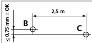
**!** Należy regularnie sprawdzać justowanie przed użyciem, po zakończeniu transportu i po dłuższym przechowywaniu.
