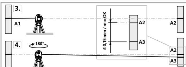
! Hvis A2 og A3 ligger mere end  $0,15 \text{ mm} / \text{m}$  fra hinanden, skal der foretages en justering. Indlevér laseren til forhandleren, som sørger for det videre fornødne, eller kontakt serviceafdelingen hos UMAREX-LASERLINER.
