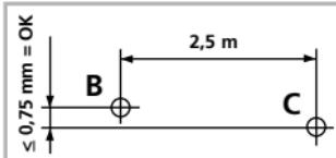
**!** Compruebe regularmente la calibración antes del uso, después de transportes y de almacenajes prolongados.
