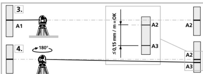
! Wanneer het verschil tussen punt A2 en A3 groter is dan de aangegeven tolerantie, nl.  $0,15 \text{ mm} / \text{m}$  is een kalibratie nodig. Neem hiervoor contact op met uw vakhandelaar of met de serviceafdeling van UMAREX-LASERLINER.
