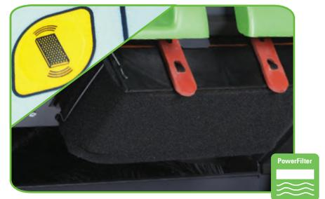
On-off automatischer Filterrüttler. Der automatische Filterrüttler kann in Zeitabständen von mindestens 1 Minute bis höchstens 8 Minuten programmiert werden. Der Filter wird in Abständen von 2 Sekunden 3 Mal für 5 Sekunden gereinigt.
